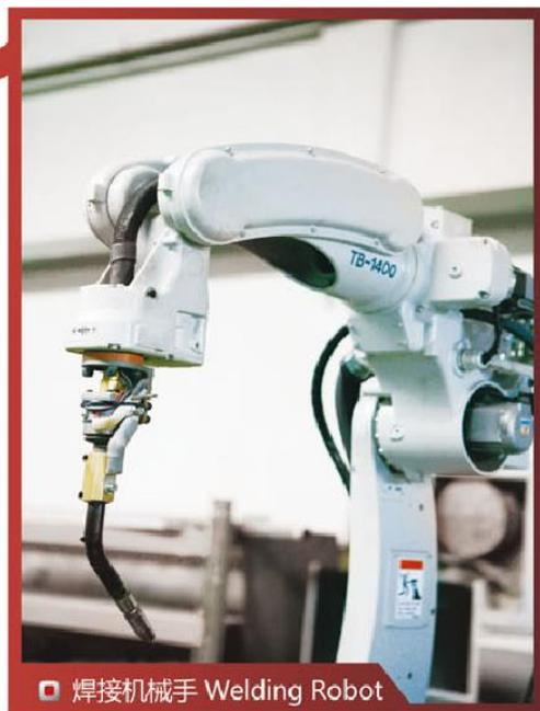
焊接机械手 Welding Robot
